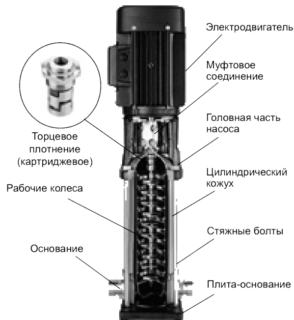
Рис. 5 Конструкция насоса CDL/CDLF
