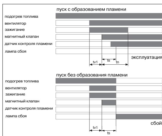
ts - контрольно-предохранительный период
